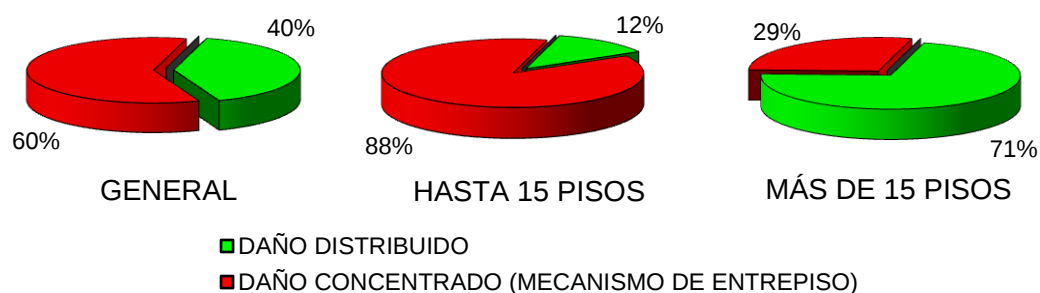
Gráfico IV.12 Distribución del daño en la altura
