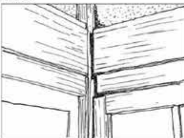
柱と梁の仕口になずれが生じている。
